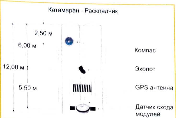
Рис. 5. Пример схемы расположения навигационного оборудования на судне-раскладчике
