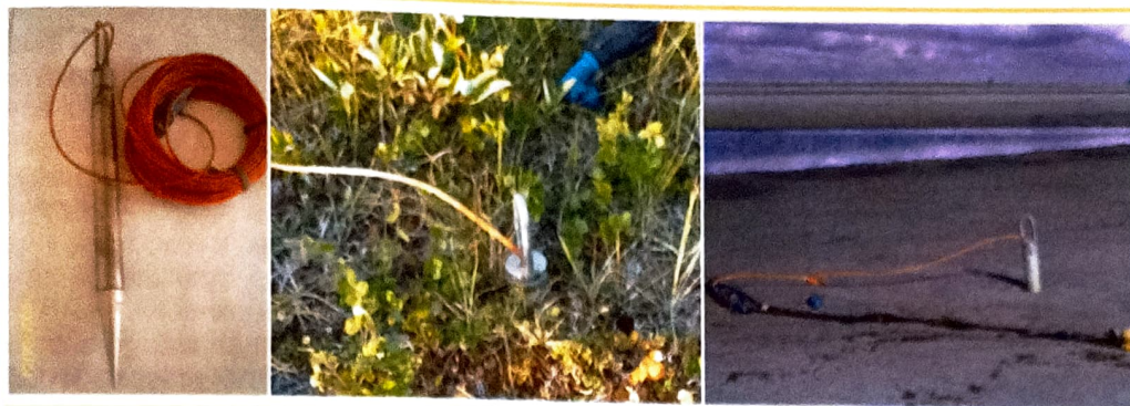
Рис. 7 Общий вид датчика с геофонами и способы их установки в тундровых условиях и прибрежной зоне
