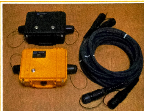
Рис. 1. Полевые блоки с комплектом 5-метровых емкостных шлейфов. 2003-2012 годы
