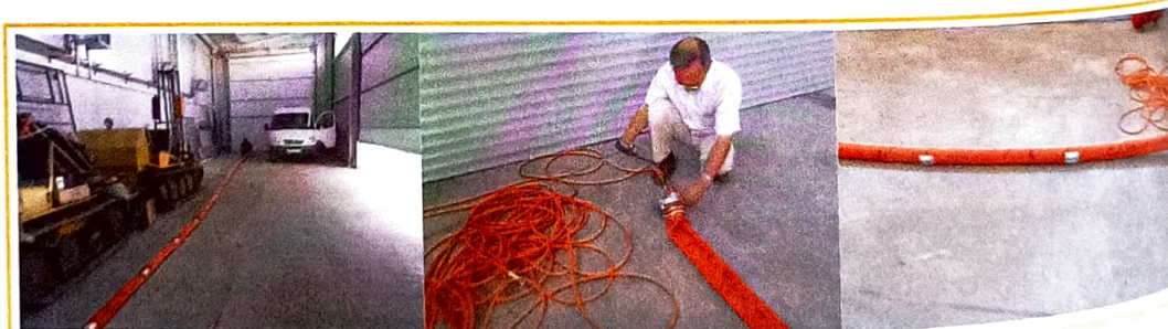
Рис.1. Конструкция скважинной косы для сейсмотомографии
