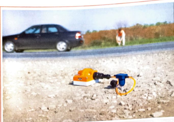
Рис. 1 Установка полевых блоков БТСС «SCOUT» на профиле
