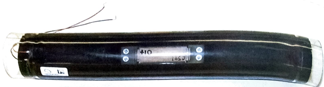
Рис.3. Запатентованный гибкий гидрофон, состоящий из 4 элементов во флюидонаполненных капсулах.
