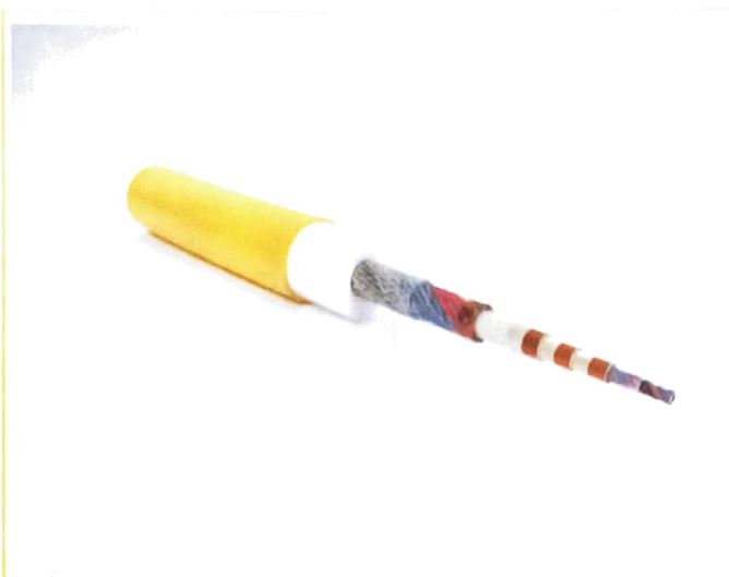
Рис. 1. Многослойное строение твёрдотельной буксируемой косы Sentinel. Гибкий несущий трос расположен в центре косы, в отличие от флюидонаполненных кос.
