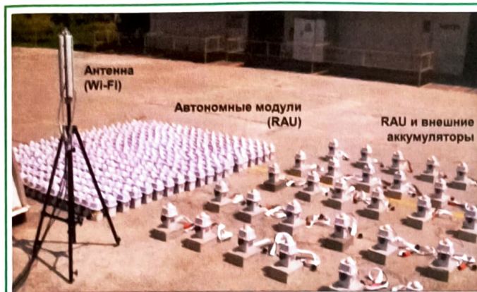
Рис.1. Программирование автономных модулей бескабельной системы на базе партии с помощью антенны Wi-Fi. Эта передвижная антенна может также использоваться для считывания сейсмических данных и контроля их качества во время полевых работ
