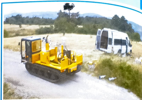
Рис. 1. Полевые работы с мини-вибратором СВ-5/300В (ЗАО «ГЕОСВИП») в бассейне Сомы
