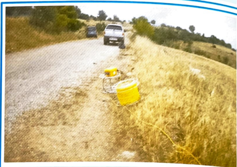
Рис. 2. Сейсмический профиль вдоль дороги (Сомы)
