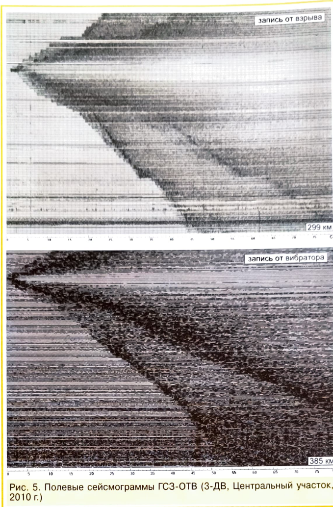
Рис. 5. Полевые сейсмограммы ГС3-ОТВ (3-ДВ, Центральный участок, 2010 г.)
