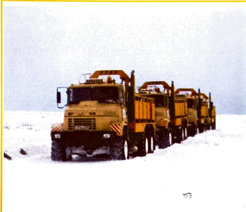
Рис. 2. Группа вибраторов CB-20/150 МТК в работе
