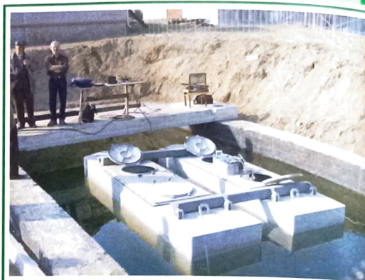
Рис.1. Макет импульсного источника на электромагнитном принципе действия для транзитных зон «Енисей-ВЭМ-100»
