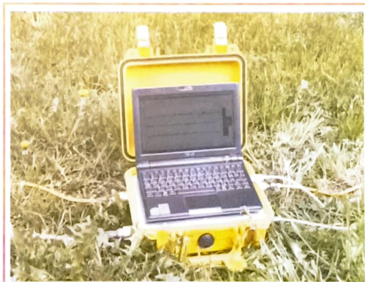
Рис 6. Сейсмостанция ЭЛЛИСС-3 МСК (ВСП).
