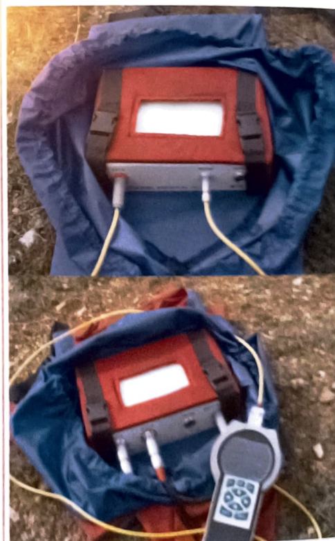
Рисунок 1. Полевой измеритель (вверху) и коммутатор тока с пультом управления (внизу) станции FastSnap.
