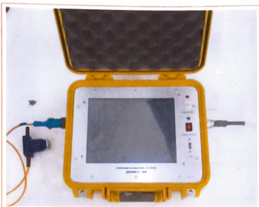
Рис 5. Вариант ЭЛЛИСС-3 со встроенным компьютером.
