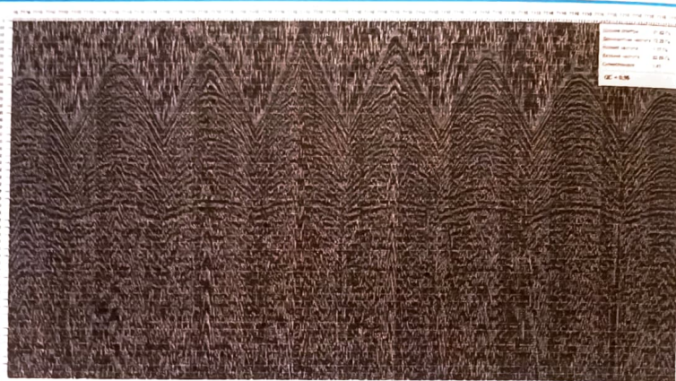
Рис. 5 Типичный вид сейсмограммы с 8-ю линиями приема, полученной в мелководной зоне
