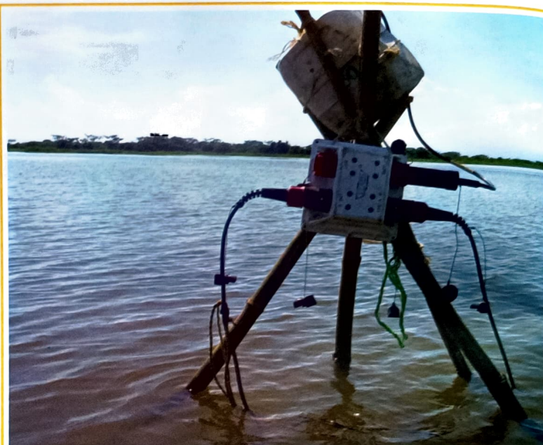
Рис.3. Традиционное наземное оборудование используется для проведения работ в пресной воде на глубине до 15 метров. При этом его необходимо предварительно несколько модифицировать в полевых условиях для снижения риска поломки в воде.
