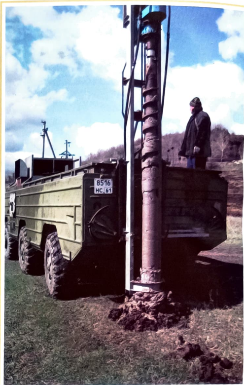
Рис.3. Амфибийный вездеход БАЗ-5921 с установкой шнекового бурения
