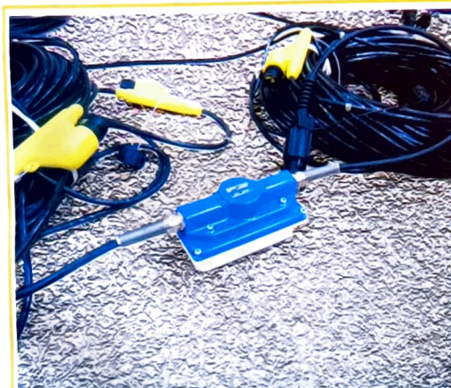
Рис. 3. Трехканальная секция с отводами для подключения сейсмогрупп
