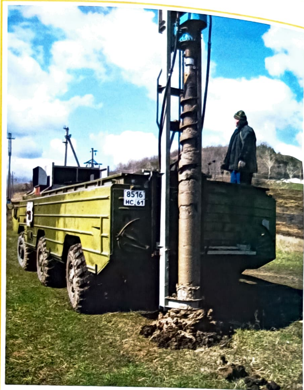
Рис 7. Скважинный пневмоисточник «КРОТ-МАЛЫШ»
