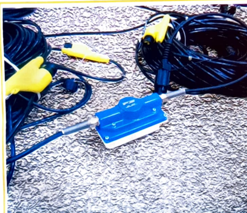
Рис. 3. Трехканальная секция с отводами для подключения сейсмогрупп
