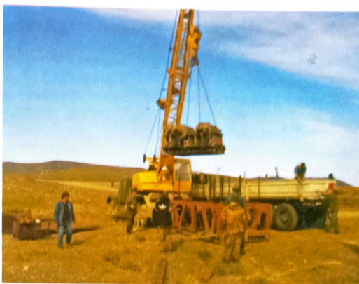
Рис.5. Передвижной (сборно-разборный) вибратор дебалансного типа ЦВП-40
