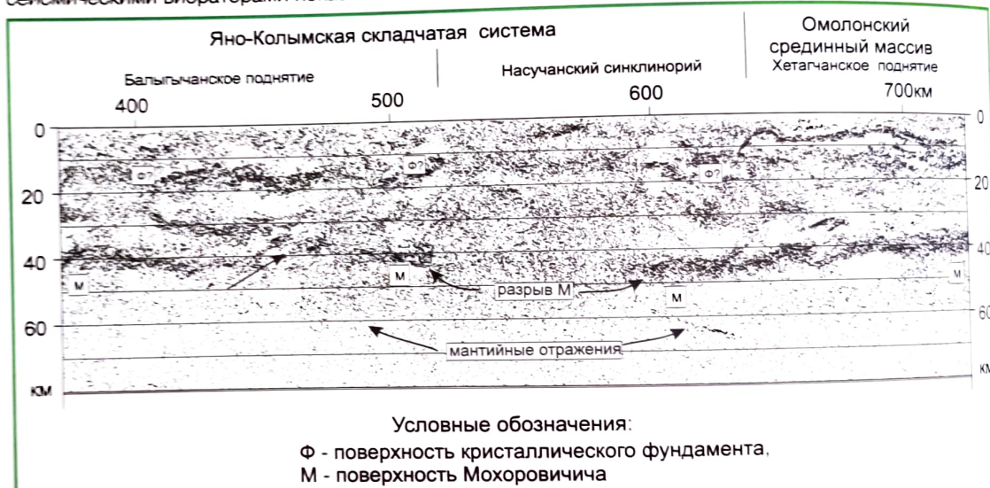
Рис.3 Глубинный разрез земной коры по данным ОГТ (фрагмент профиля 2-ДВ)
