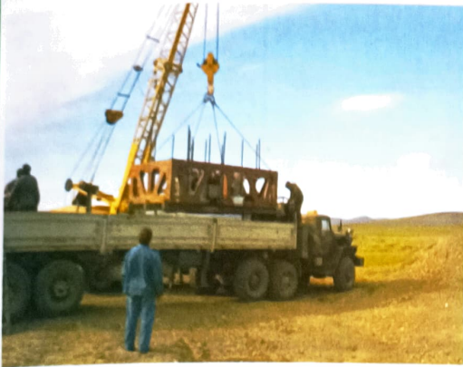
Рис.5. Передвижной (сборно-разборный) вибратор дебалансного типа ЦВП-40
