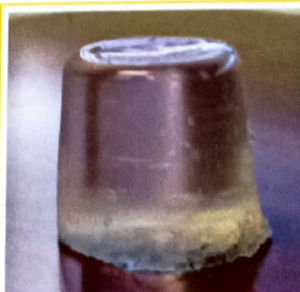
Рис. 2. Запатентованный гелевый наполнитель для сейсмической косы
