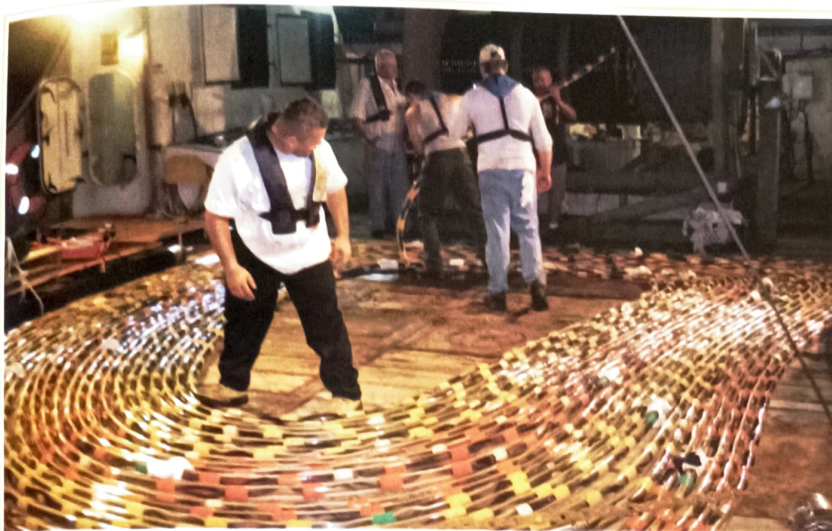
Рис. 5. Секции с гелевым наполнителем системы DigiSTREAMER более гибки, просты в обращении и снижают риски в области охраны труда и окружающей среды.
