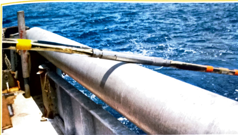
Рис. 1. Система DigiSTREAMER – электронный модуль, головная и хвостовая рабочие секции.
