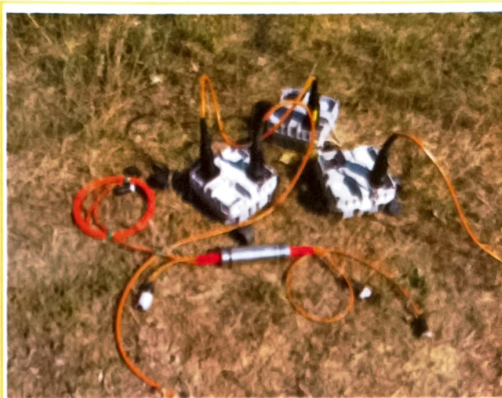
Рис. 3. Смешанная расстановка шести- и одноканальных блоков сбора данных для преодоления водных преград.
