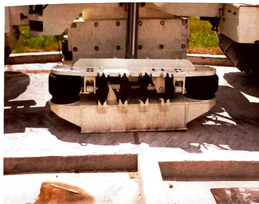
Рис.9. Вибратор на цементном покрытии, полигон Сили в штате Техас
