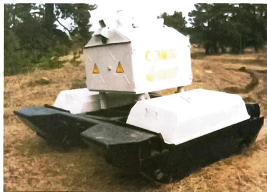
Рис.2. Электромагнитный источник «Енисей-СЭМ-50». Предназначен для проведения сейсморазведки в зимний период в труднопроходимых районах горно-таежной и тундровой местности, на ледовых покровах водоемов
