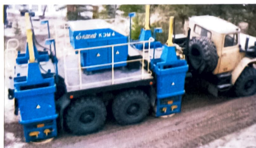
Рис. 8. Электромагнитный источник «Енисей-КЭМ-4». Предназначен для проведения сейсморазведки как в летний, так и в зимний периоды в районах горно-таежной, степной и тундровой местности
