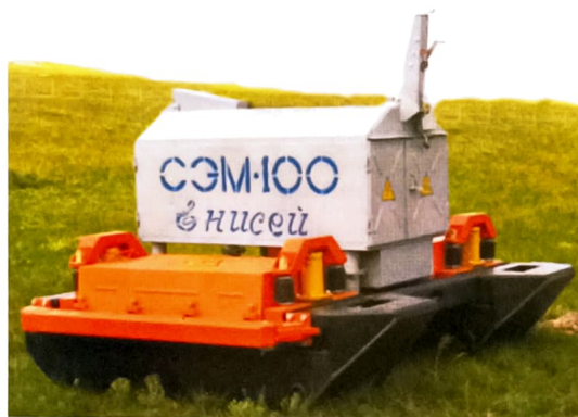
Рис.3. Электромагнитный источник «Енисей-СЭМ-100». Является наиболее распространенной и востребованной моделью источника для проведения сейсморазведки в зимний период. Предназначен для работы в условиях горно-таежной и тундровой местности
