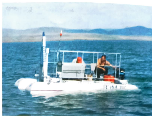
Рис. 9. Электромагнитный источник «Енисей-ВЭМ-100», водный вариант. Предназначен для проведения сейсморазведки в летний период, в условиях водных акваторий
