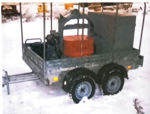
Рис. 5. Электромагнитный источник «Енисей-КЭМ-1». Предназначен для изучения сейсмическими методами зоны малых скоростей (ЗМС) и верхней части разреза (ВЧР). Конструктивно выполнен в виде прицепа к автомобилю
