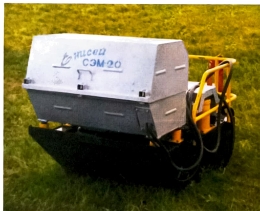
Рис.1. Электромагнитный источник «Енисей-СЭМ-20». Предназначен для оперативной транспортировки авто- и авиатранспортом к месту проведения сейсмокаротажа и ВСП неглубоких скважин
