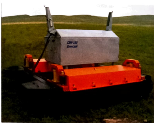
Рис.4. Электромагнитный источник «Енисей-СЭМ-180». Источник повышенной мощности, предназначен для проведения сейсморазведки в зимний период, в районах горно-таежной и тундровой местности при ограниченной базе группирования источников
