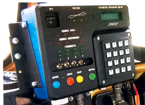
Рис. 2. Устройство синхронизации и управления SGD-SP (Версия V1.x.x)
