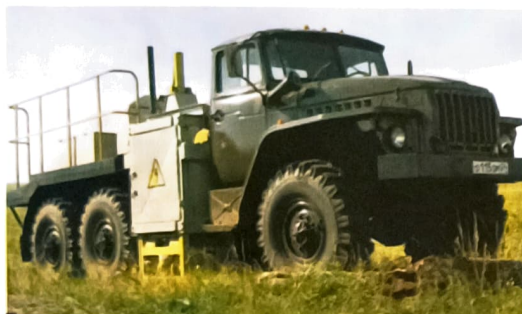
Рис. 6. Электромагнитный источник «Енисей-КЭМ-2». Является наиболее распространенной колесной моделью источника, предназначен для проведения сейсморазведки, как в летний, так и в зимний периоды в районах горно-таежной, степной и тундровой местности
