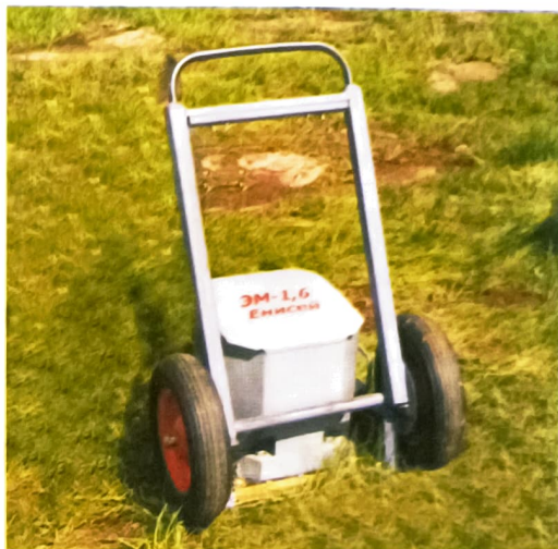
Рис. 10. Электромагнитный источник «Енисей-ЭМ-1.6», малогабаритный вариант. Предназначен для инженерных сейсмических исследований поверхностной части разреза
