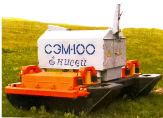
Рис.3. Электромагнитный источник «Енисей-СЭМ-100». Является наиболее распространенной и востребованной моделью источника для проведения сейсморазведки в зимний период. Предназначен для работы в условиях горно-таежной и тундровой местности
