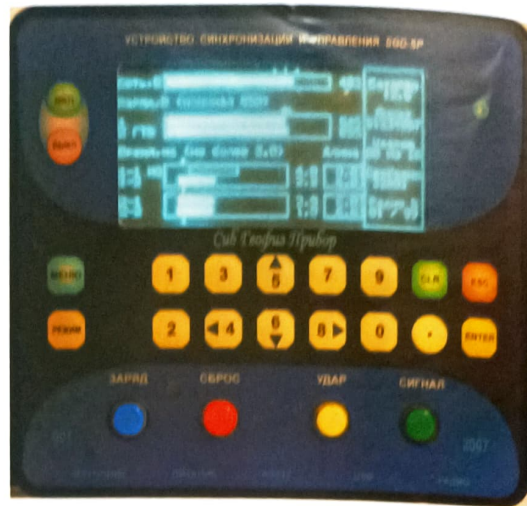
Рис. 9. Устройство синхронизации и управления SGD-SP (Версия V3.x.x)
