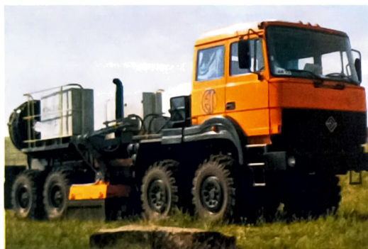
Рис. 7. Электромагнитный источник «Енисей-КЭМ-2-130». Источник смонтирован на автомобиле «Урал» повышенной проходимости. Предназначен для проведения сейсморазведки в летний и зимний периоды в труднопроходимых районах горно-таежной, тундровой, степной и пустынной местности
