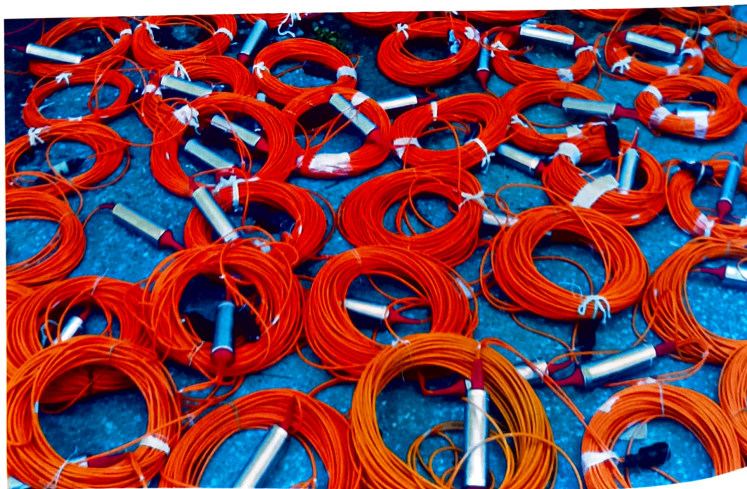
Рис. 3. Блоки наземного комплекса телеметрической сейсморегистрирующей системы "Прогресс - Т155"
