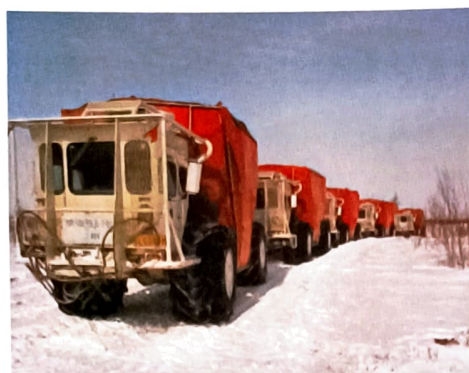
Рис. 1. Группа вибрационных источников в работе: а) вибраторы KZ-23B на профиле; б) вибраторы NOMAD 65T на профиле
