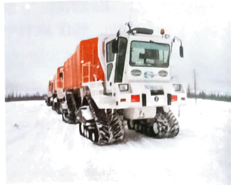
Рис. 1. Группа вибрационных источников в работе: а) вибраторы KZ-23B на профиле; б) вибраторы NOMAD 65T на профиле
