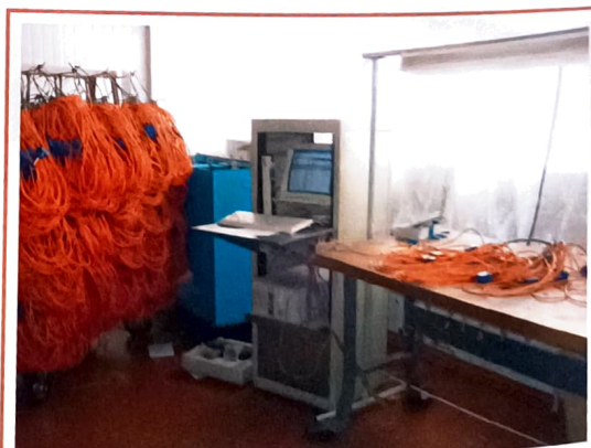
Рис. 2. Тестирование групп сейсмоприемников.
