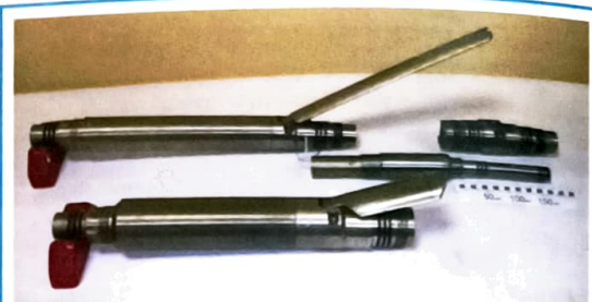
Рис. 3 Прижимные устройства для скважинной геофизической аппаратуры
