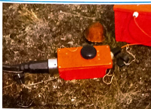
Рис.1. Автономный сейсмический регистратор РОСА-А
