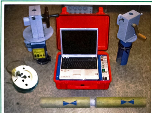
Рис. 5. Георадарный скважинный комплекс.
