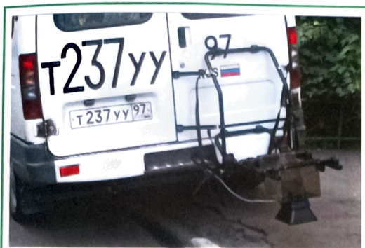
Рис. 4. Рупорный антенный блок АБ-1700-Р, смонтированный на автомобиле.
