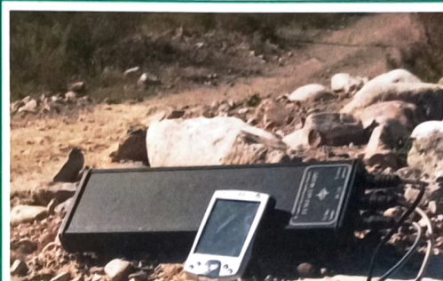
Рис. 1. Аппаратура TEM-FAST 48 HPC и карманный компьютер HP Ipaq 2210.
