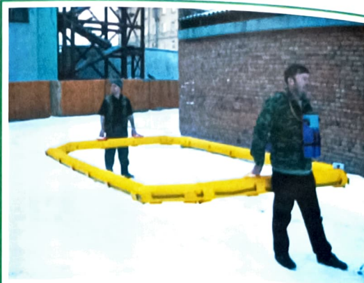
Рис. 2. Пневматическая приемно-генераторная установка для съемки в движении.
