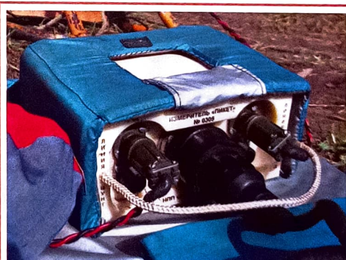
Рис. 3. Полевой измеритель телеметрической станции «ПИКЕТ».
