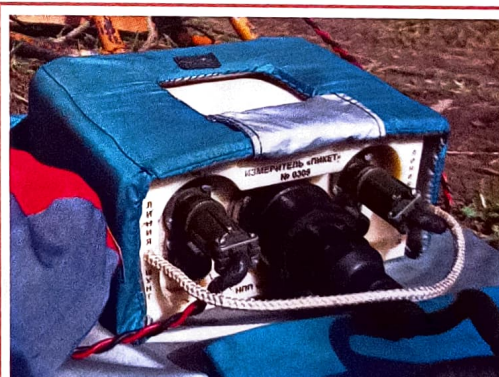
Рис. 3. Полевой измеритель телеметрической станции «ПИКЕТ».
