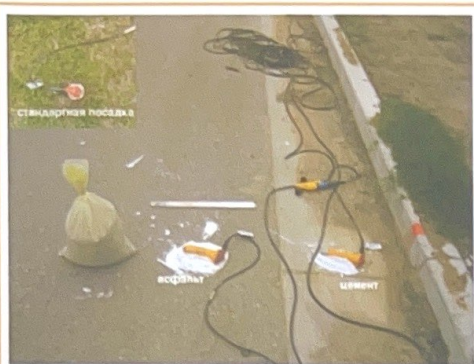
Рис. 3. Расположение тестовых сенсоров.
