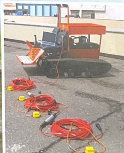
Телеметрическая станция "ТЕЛСС"
