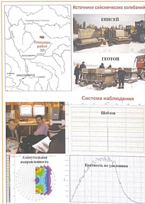
Рис. 1. Методика сейсморазведочных работ 3D на Юрубченской площади.
