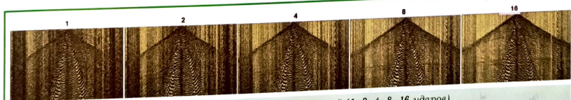
Рис. 3. Сейсмограммы, полученные с разным числом накоплений (1, 2, 4, 8, 16 ударов).
