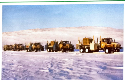
Рис. 1. Группа электромагнитных источников "Енисей КЭМ-4" при работе по региональному профилю "Диксон - оз. Хантайское".
