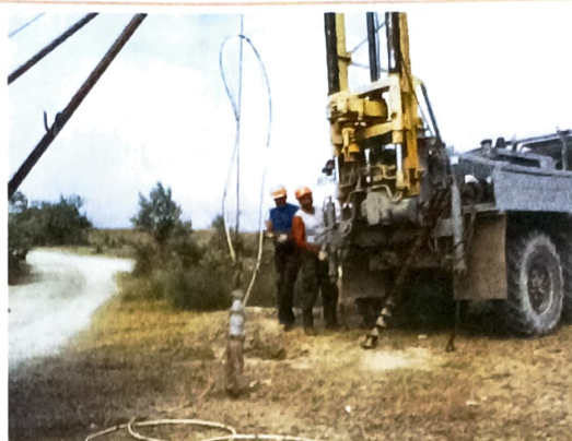
Рис. 4. Взрыв-пункт для выполнения возбуждения упругих колебаний на суше.
