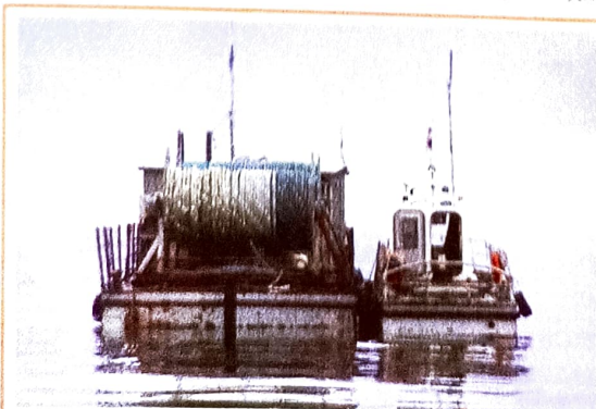
Рис. 2. Катамаран сейсмостанция (осадка 0,6 м).
