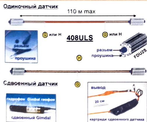
Рис. 2. WPSRD кабель и цифровые полевые модули системы 408ULS. Выводы для датчиков имеют различное расположение, в зависимости от предназначения кабеля для одиночного датчика или сдвоенного (G: геофон; H: гидрофон).
