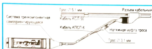
Рис. 3 Условная схема буксируемой косы с применением трехкомпонентной самоориентирующейся системы
