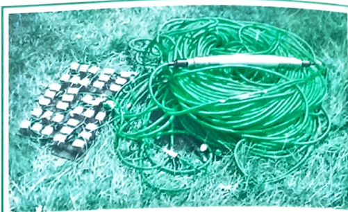
Рис. 2 Фрагмент сейсмической телеметрической косы системы ССТ-480
