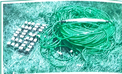
Рис. 2 Фрагмент сейсмической телеметрической косы системы ССТ-480
