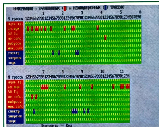
Рис. 3 Вид экрана дисплея при текущем анализе качества записи сейсмограммы на рис.1
