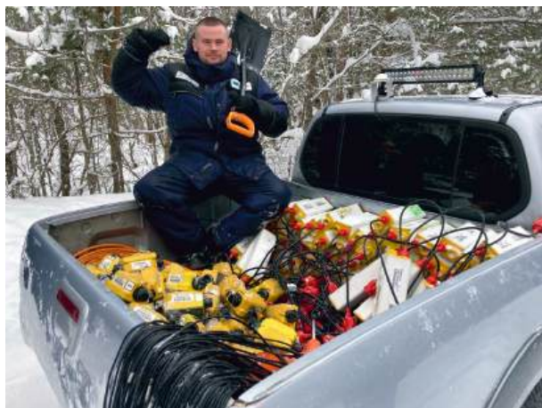
▼ Рис. 9. Бескабельная станция GSX в кузове пикапа.
