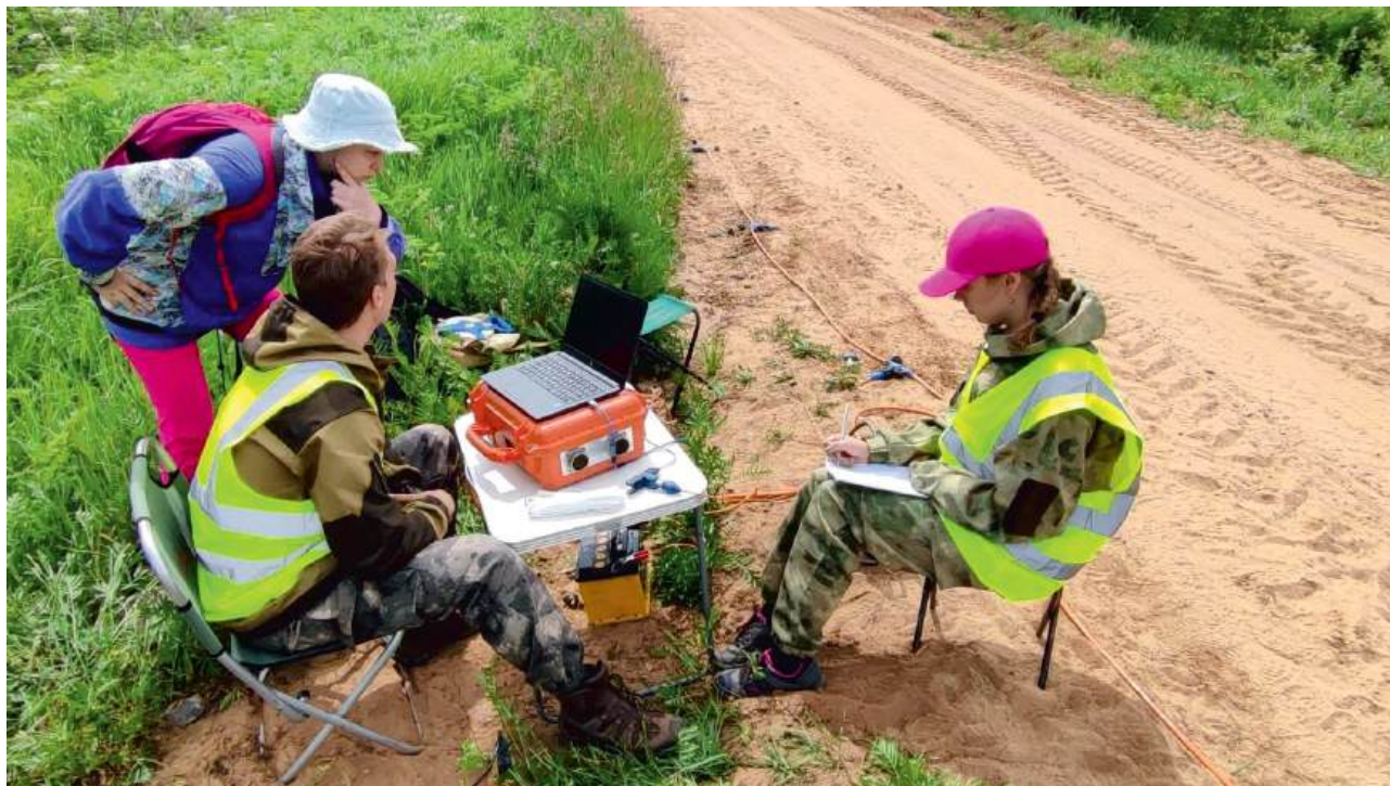
▲ Рис. 8. Сейсморазведочная система ЭЛИСС-3 на 48 каналов в рабочий момент.
