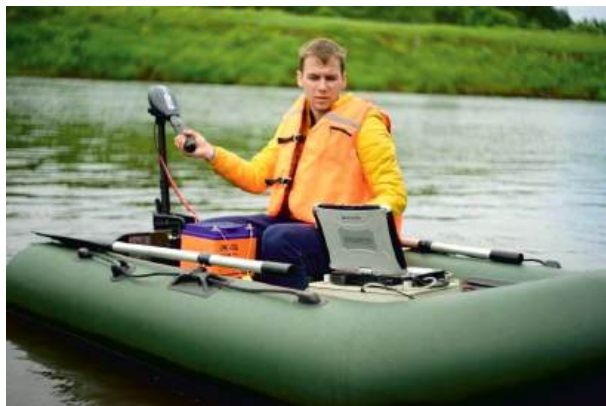
▲ Рис. 6. Выполнение задачи ГРЛ: картирование дна рек и границ поддонных отложений.
