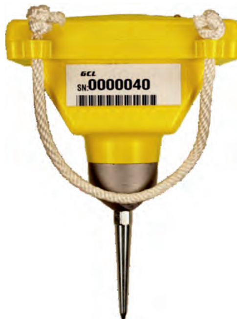
▼ Рис. 1. Автономный регистратор GCL, производства Geospace Technologies Corporation (используется геофон GS-ONE или GS-ONE LF с частотой 4.5, 5 или 10 Гц).
