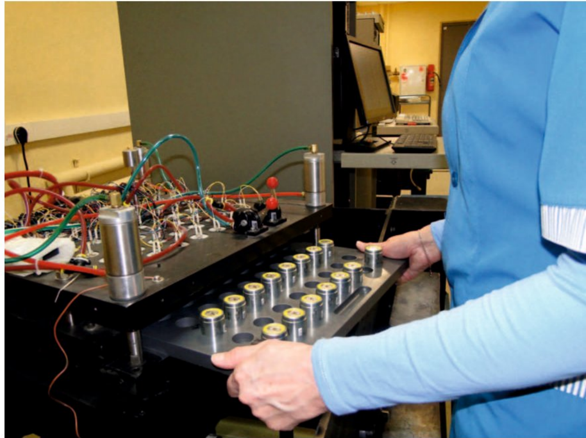
Рис.3 Автоматическая тестирующая станция
