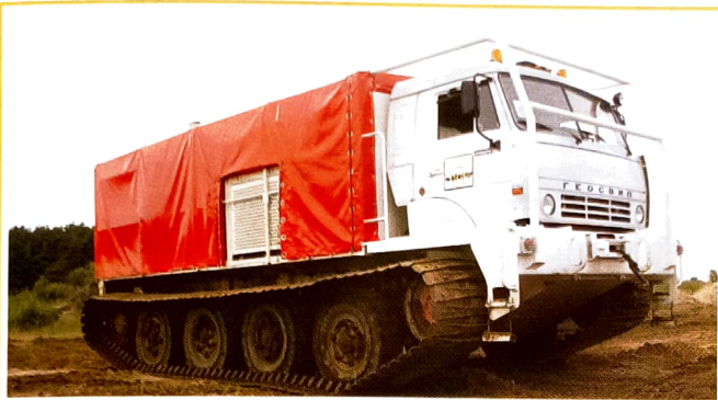
Фото 2. СВС-24/РС 27 на гусеничном снегоболотоходном шасси, с усилием 27 тс.
