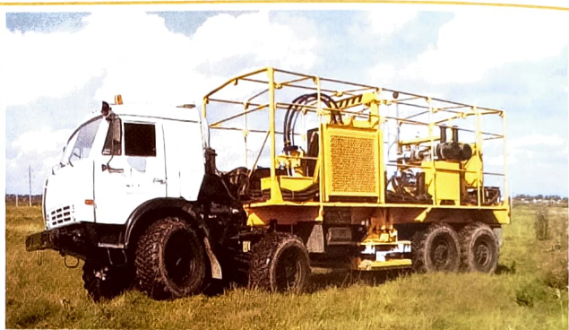
Фото 1. СВ 27/150К на шасси а/м КАМАЗ -6350 (8x8), с усилием 27тс
