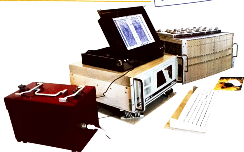
Рис.2 Внешний вид 128-и канальной сейсмостанции «Прогресс-Л» (портативное исполнение)
